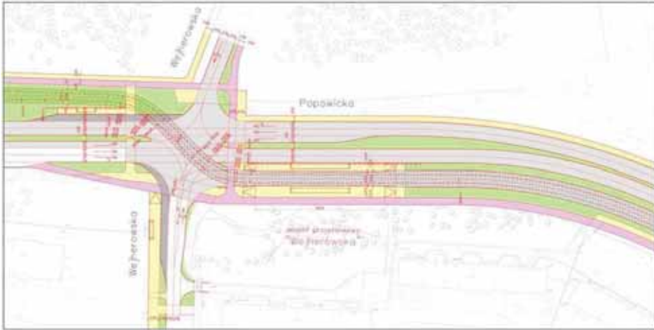
Rys. 9. Wariant klasyczny przejścia torowiska na przeciwną stronę ulicy Popowickiej na skrzyżowaniu z ulicą Wejherowską
