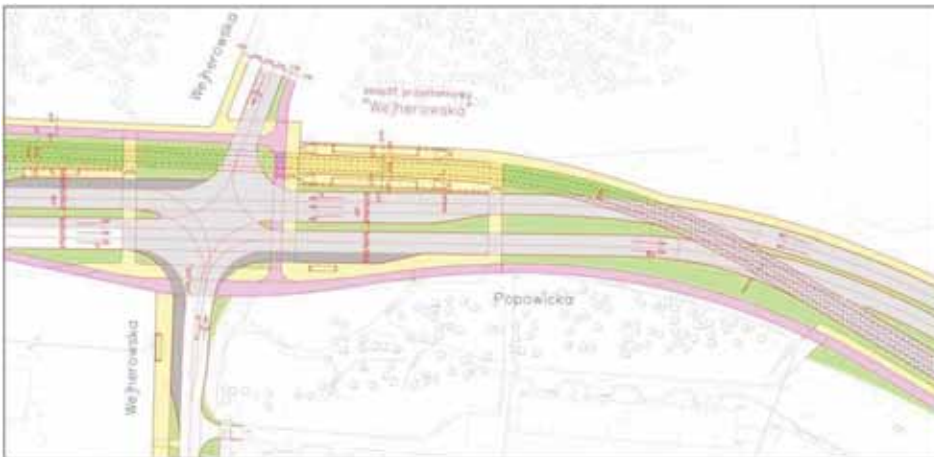
Rys. 10. Wariant alternatywny przejścia torowiska na przeciwną stronę ulicy Popowickiej na przed skrzyżowaniem z ulicą Wejherowską
