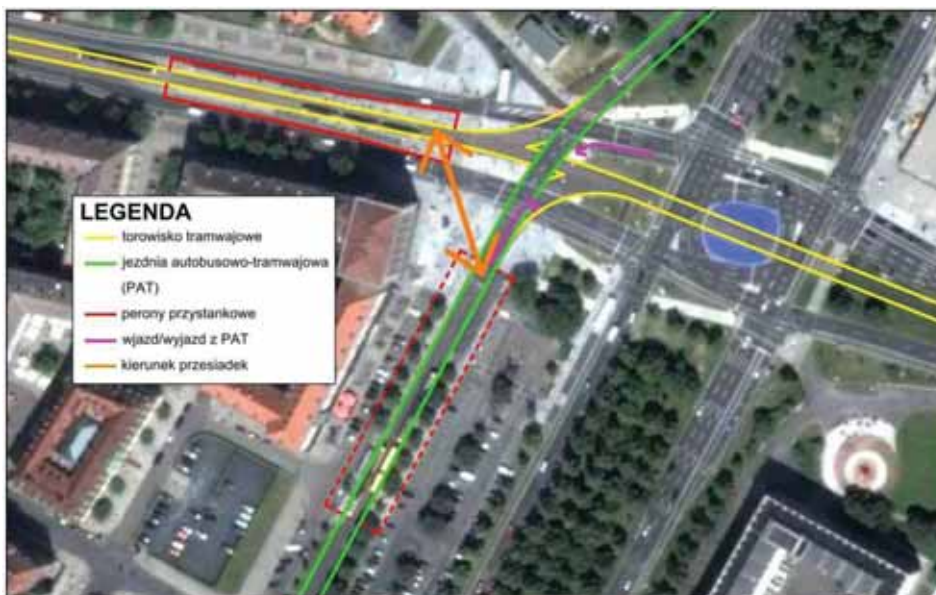
Rys. 3. Schemat urządzenia Pirnaischer Platz w Dreźnie pod kątem komunikacji zbiorowej. Warto zwrócić uwagę, że w miejscu tym między 2006 a 2011 rokiem zlikwidowano przejścia podziemne na rzecz przejść w poziomie terenu.
