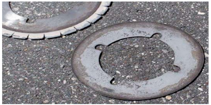
Fot. 4. Tarcza piły diamentowej oraz przekładka dystansowa umieszczona pomiędzy piłami [7]
