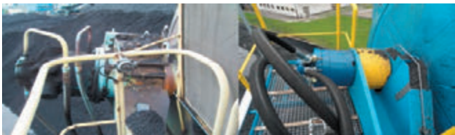
Rys. 4. Modernizacja napędu koła czerpakowego (po lewej stronie przed modernizacją, po prawej stronie po modernizacji) [1]
