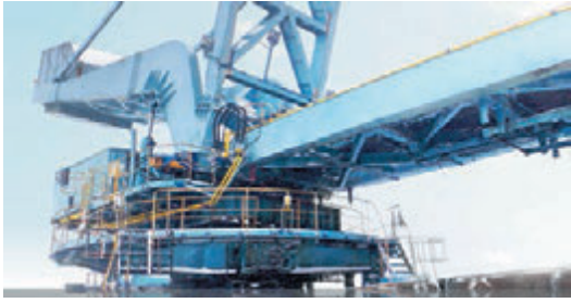
Rys. 1. Zmodernizowana ładowarka ŁWKS na placu węglowym [1]
