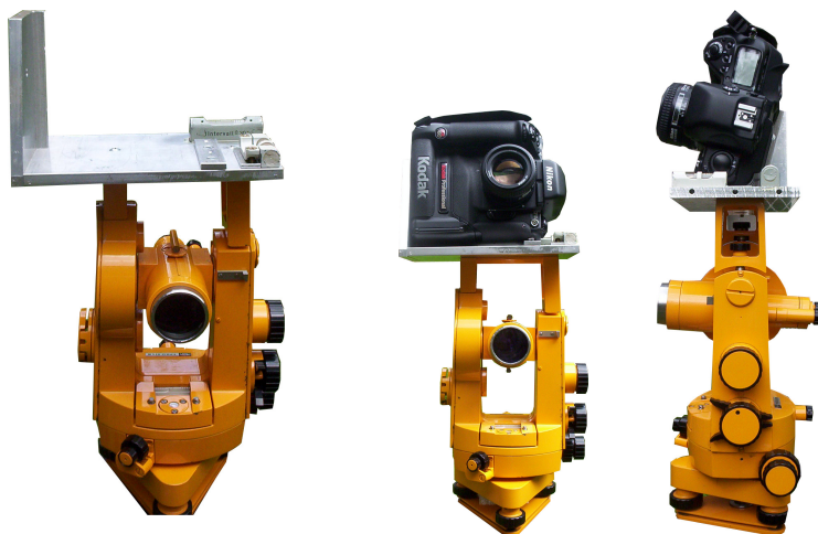
Urządzenie mocujące zamocowane na teodolicie
