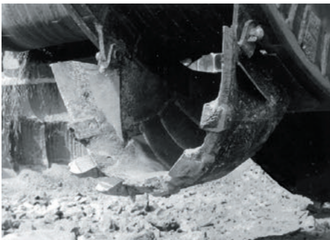
Fig. 3. Worn out teeth due to abrasion and breaks Rys. 3. Zużyte zęby przez scieranie i wyłamania
