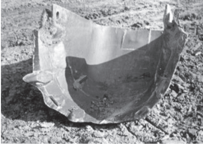
Fig. 2. Worn out bucket – visible are broken teeth and knife damages Rys. 2. Czerpak zużyty - widoczne wyłamania zębów i uszkodzenia noża
