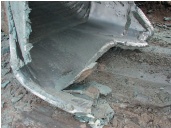
Fig. 4. Total damaged bucket Rys. 4. Całkowite zniszczenie czerpaka
