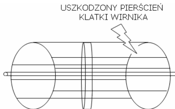
Rys. 6. Uszkodzony pierścień klatki wirnika silnika synchronicznego
