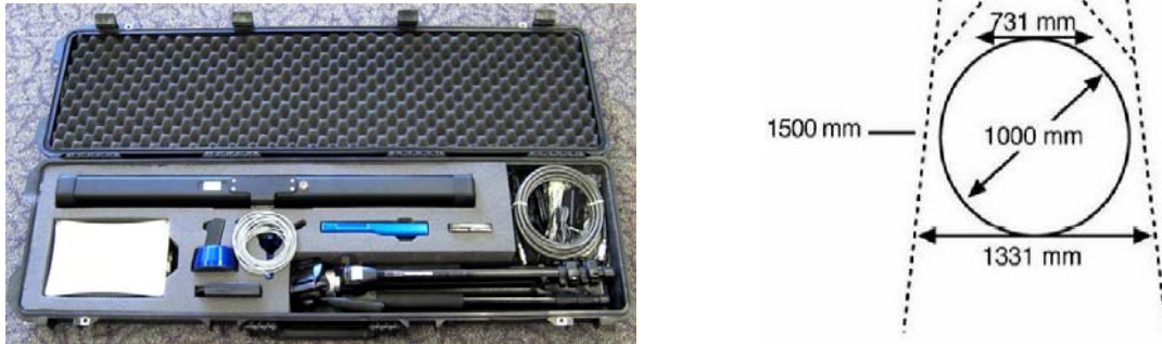
Fig. 2. Measuring device and operational radius of the 800 mm scanner sensor Rys. 2. Urządzenie pomiarowe oraz promień działania 800 mm czujnika skanera
