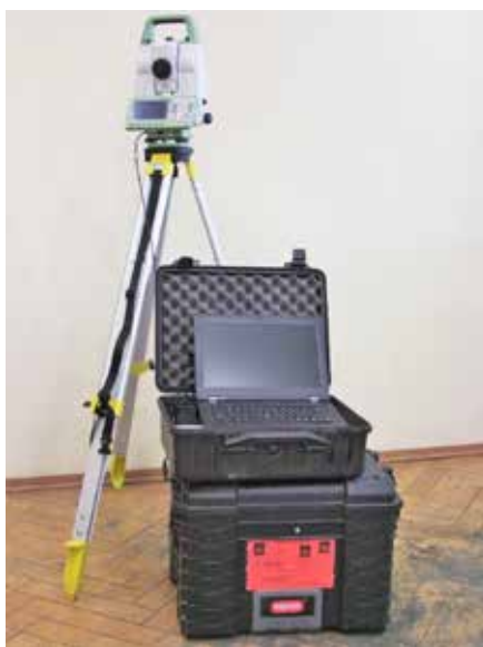
Rycina 2. Przykładowy system do badania statyki konstrukcji, oparty na teodolicie oraz oprogramowaniu geodezyjnym
