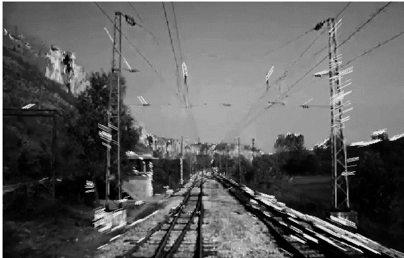
Rys. 9. Kadr z filmu wraz z wykrytymi parami punktów (względem następnej klatki filmu)
