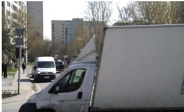
Rys. 2. Przykład zniekształcenia obrazu samochodu, poruszającego się w lewo, prostopadle do osi celowej kamery
