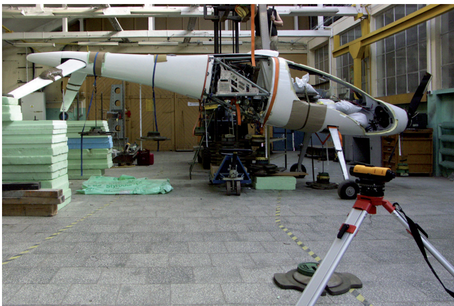
Rys. 3. Próba wytrzymałości na obciążenie statyczne 3g wiatrakowca [W. Krzymień 2012]
