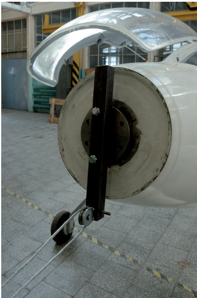
Rys. 9. Próba wytrzymałości łoża piasty śmigła [W. Krzymień 2013]
