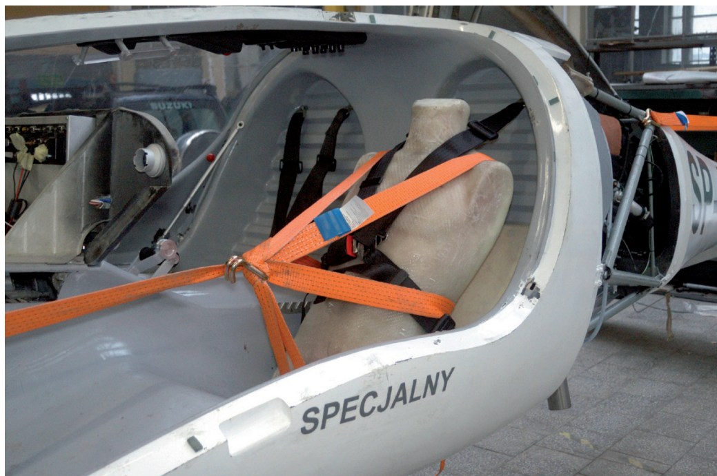
Rys. 8. Próba wytrzymałości pasów bezpieczeństwa i ich mocowania [W. Krzymień 2013]
