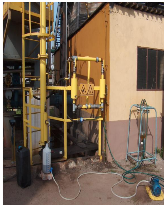
Rys. 2. Schemat skrubera do wymywania naftalenu oraz widok całego układu
