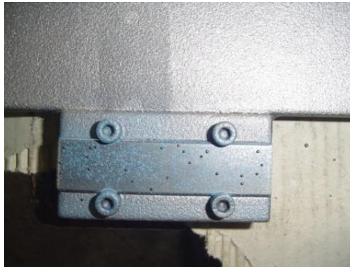
Rys. 10. Widok powierzchni płytki Almena ze śladami uderzeń śrutu, stanowisko oczyszczarki OWS-1000, śrut staliwny kulisty [4]
