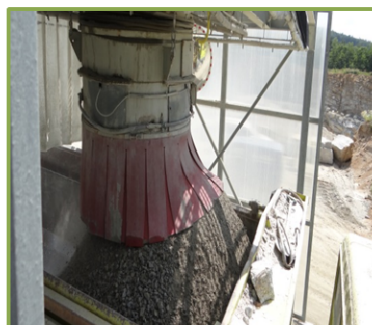
Rys.9. Załadunek kruszywa 0/32 rękawem teleskopowym - odpylana i zraszana stacja załadunkowa w kopalni Wieśnica (fot. M.Stefanicka)
