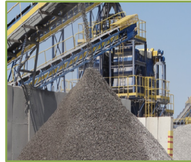
Rys. 3. Widok magazynu produkcyjnego w kopalni Łaźany - zraszany stożek 16/22 (fot. M. Stefanicka)
