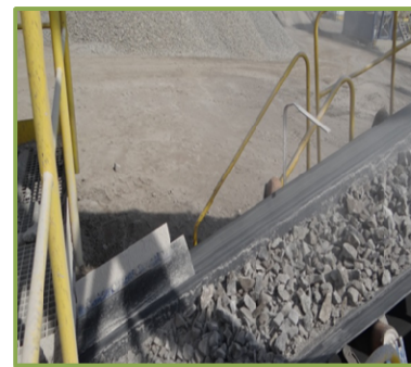
Rys. 5. Widok wysypu z kruszarki II stopnia przerobu w kopalni Łaźany - zraszanie włączone (fot. M. Stefanicka)
