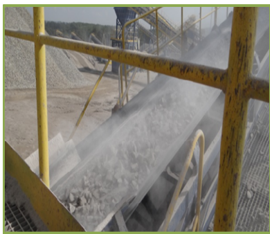
Rys. 4. Widok wysypu z kruszarki II stopnia przerobu w kopalni Łaźany - zraszanie wyłączone na czas pomiarów (fot. M. Stefanicka)
