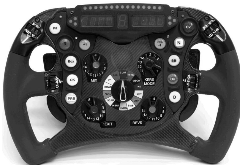
Rys. 1. Widok kierownicy wyścigowej zintegrowanej z pulpitem kierowcy [4]
