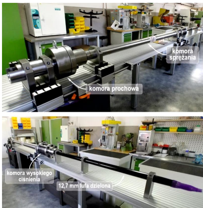
Rys. 13. Widok stanowiska dwustopniowego układu miotającego po montażu wstępnym
