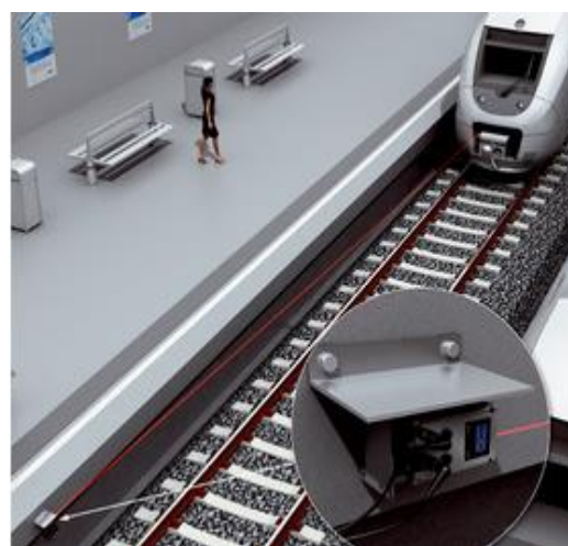
Rys. 2. Określanie pozycji pociągów na stacjach [1]
