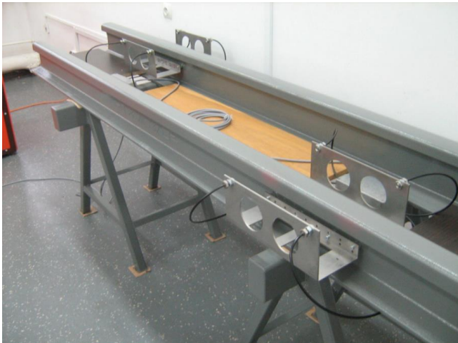
Rys. 7. Bazy pomiarowe zamocowane do szyn jezdnych (możliwość pracy w warunkach rzeczywistych) [fot. autor]
