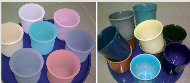
Rys. 3. Widok surowych kubków porcelitowych po naniesieniu szkliwa przed wypaleniem i po wypaleniu.
