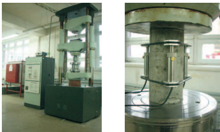
Rys. 7. Widok maszyny wytrzymałościowej z zamontowanymi na próbce czujnikami pomiarowymi do oznaczania modułu sprężystości
