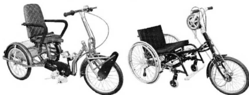
←Rys. 3. Napęd mieszany: wahadłowo (ręce) – korbowy (nogi).
