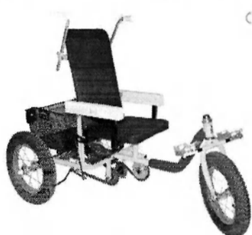
Rys. 5. Pojazd rehabilitacyjny napędzany wahadłowym oparciem
