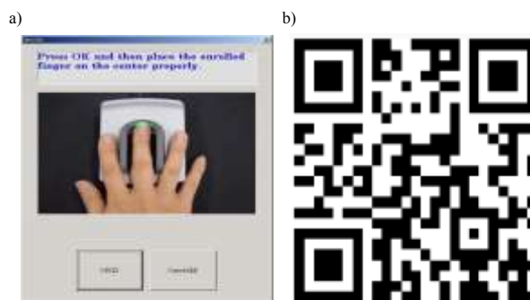
Rys. 4. Testy urządzeń, badających cechy biometryczne a) pobranie wzorca biometrycznego palca w postaci układu naczyń krwionośnych
