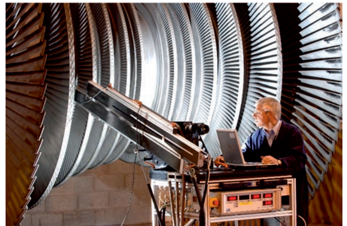
Fig. 2. Rotor Disc Bore Inspection Rys. 2. Badanie koła wirnika
