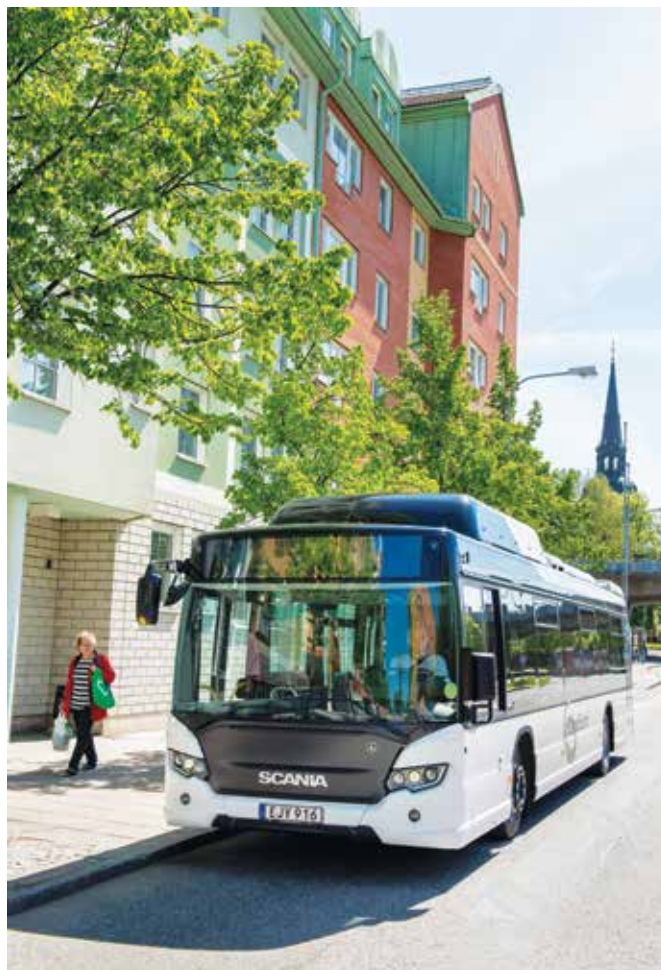
Autobus Scania Citywide zasilany sprężonym gazem ziemnym (CNG)
