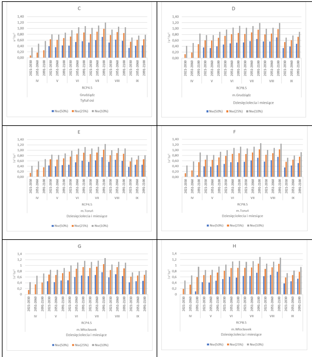
Rysunek 4. Zapotrzebowanie na wodę w nawadnianiu podsiąkowym o zmiennym zwierciadle wody Figure 4. Water demand in upward irrigation with variable water table
