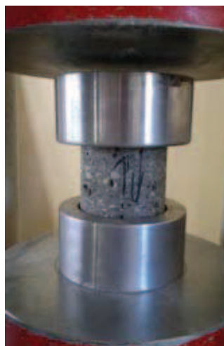
Rys. 3. Próбка w czasie badania wytrzymałości na ściskanie w maszynie wytrzymałościowej
