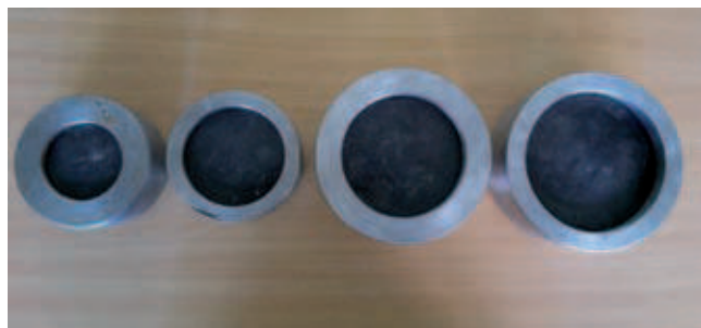
Rys. 2. Krążki stalowe z podkładkami neoprenowymi
