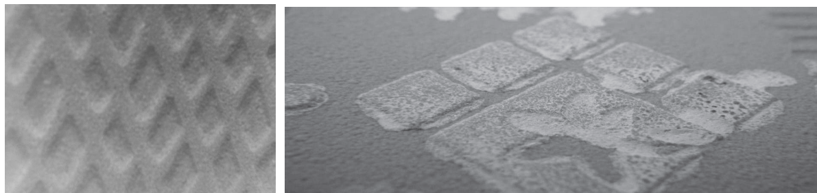
Ryc. 1. Przykłady zróżnicowania powierzchni spodniej płytek gresowych dostępnych w obrocie handlowym
