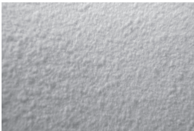
Ryc. 2. Zdjęcie spodniej powierzchni płytki normowej stosowanej standardowo w badaniach
