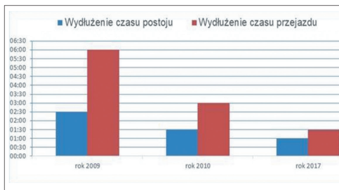
Rys. 3. Maksymalne wydłużenie czasu postoju pociągów i wydłużenie czasu przejazdu na linii metra M1
