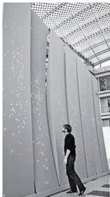
Rys. 16. Interactive Wall, Hyperbody, TU Dresden, Festo 2009 – kinetyczność architektury polega na ruchu fragmentów budynku, odpowiadając na warunki środowiskowe i potrzeby użytkownika, elementy interaktywne zmieniają geometrię za sprawą wbudowanych sensorów, procesorów i aktuatorów pneumatycznych Fig. 16. Interactive Wall, Hyperbody, TU Dresden, Festo 2009 – interactivity is addressed here at the level of building fragments that become dynamic, responding to environmental factors or user specific needs, the real-time interactive elements are activated via embedded sensor and pneumotronic actuators
