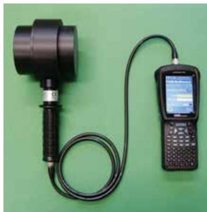
Rys. 5. Przyrząd pomiarowy wartości siły zamykania drzwi (Tür-Schließkraftmessgerät) typu TM, HGE GmbH Źródło: archiwum autora.
