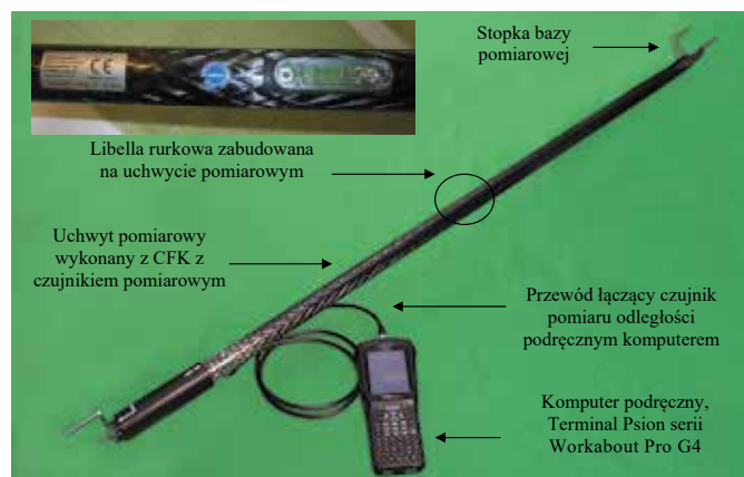
Rys. 2. Przyrząd do pomiaru odległości wewnętrznych płaszczyzn kół zestawów kołowych (Radabstandsmessgerät A_R -Maß Typ: HGE-WD), HGE GmbH
