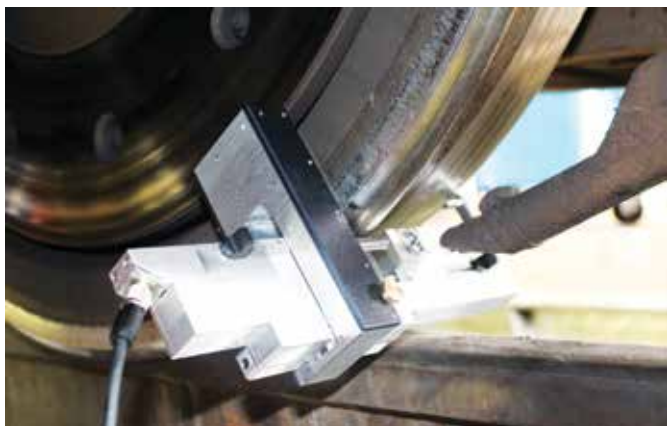
Rys. 4. Profilmierz elektroniczny do kół kolejowych i tramwajowych – Radmessgerät Bahn, HGE GmbH Źródło: archiwum autora.
