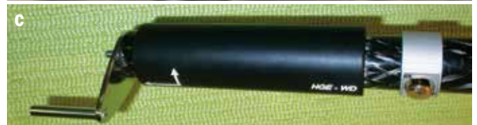
Rys. 3. Pomiar odległości wewnętrznych płaszczyzn kół zestawów kołowych z zastosowaniem przyrządu Radabstandsmessgerät AR-Maß Typ: HGE-WD: a) punkt pomiarowy, b) odległość wewnętrzna płaszczyzn kół zestawu kołowego (kolor czerwony), szerokość toru (kolor zielony), c) czujnik pomiarowy Źródło: archiwum autora.
