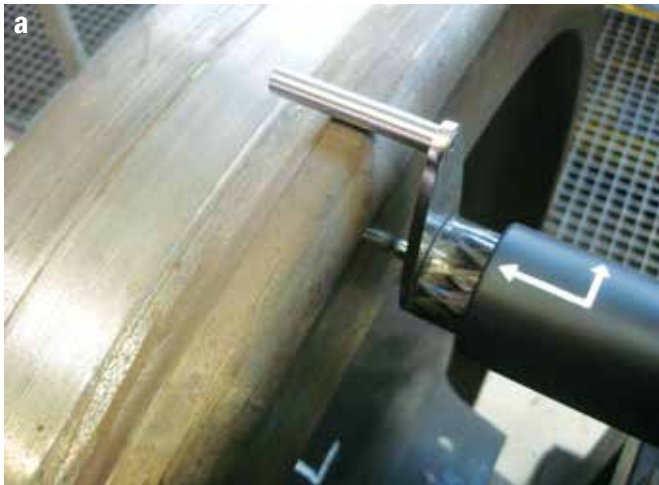
Rys. 3. Pomiar odległości wewnętrznych płaszczyzn kół zestawów kołowych z zastosowaniem przyrządu Radabstandsmessgerät AR-Maß Typ: HGE-WD: a) punkt pomiarowy, b) odległość wewnętrzna płaszczyzn kół zestawu kołowego (kolor czerwony), szerokość toru (kolor zielony), c) czujnik pomiarowy Źródło: archiwum autora.
