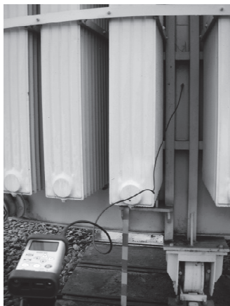
Rys. 1. Rejestrator sygnału drgań i czujnik akcelerometryczny przymocowany do kadzi diagnozowanego transformatora
