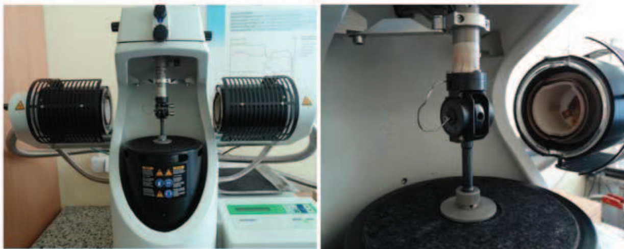
Rys. 2. Aparatura badawcza (po lewej) oraz mocowanie próbki podczas badania DMTA (po prawej) Fig. 2. Research equipment (on the left) and fixing of the specimen during the test DMTA (on the right)
