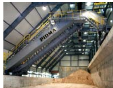
Wygarniacz półportalowy PIOMA PPUZ 200 w Elektrowni Ostrołęka
