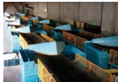
Układ rozładunku przenośników w Elektrowni Pątnów
