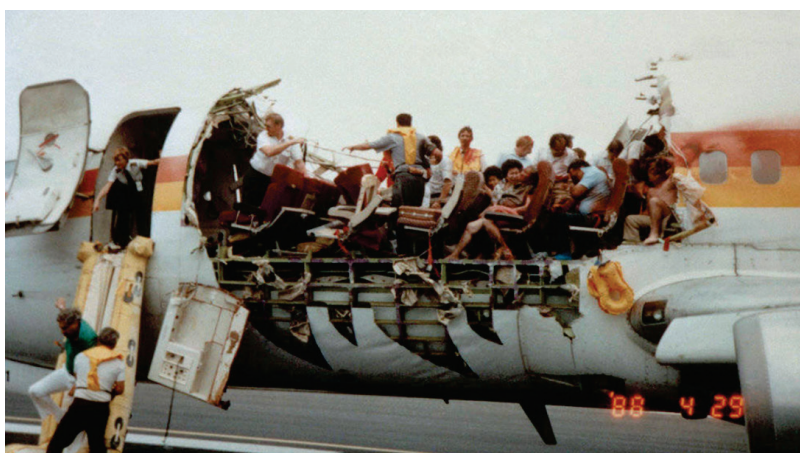
Rys. 4. Widok uszkodzeń pokrycia samolotu linii Aloha Airlines po wylądowaniu na lotnisku w Kuhului [5]
