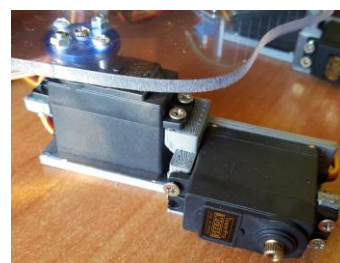
Rys. 18. Połączenie koszyka z serwonapędami
