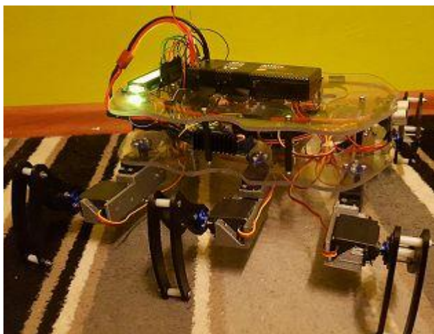
Rys. 20. Wykonany 6-cio nożny robot krocący
