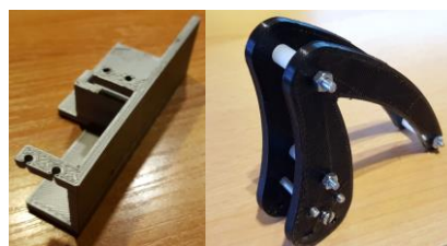
Rys. 16. Koszyki i noga wykonane technologią druku 3D
