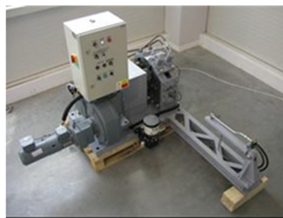
Rys. 1. a) Zasada procesu DRECE, b) Urządzenie formujące Fig. 1. a) Principle of DRECE process, b) Forming equipment
