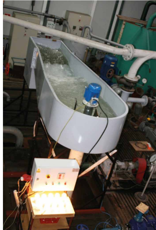
Rys. 14. Widok na stanowisko pomiarowe w wariacie badawczym z obciążeniem turbiny generatorem. Widoczny układ pomiaru i odbioru mocy systemem żarówek
