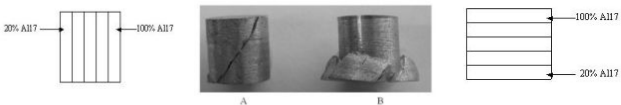
Rys. 4. Próbki z materiału gradientowego po ściskaniu w temperaturze pokojowej siłą przyłożoną: A – prostopadle, B – równolegle do gradientu składu chemicznego
