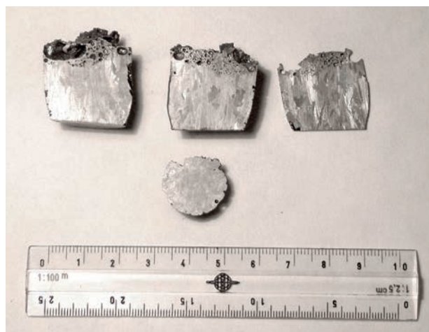
Rys. 14. Widok przekrojów podłużnych ze strukturą polikrystaliczną w kryształach Bi 2-x Ca x Se 3 nr BS-6 domieszkowanym wapniem (Ca) z wyraźnie widoczną, porowatą strukturą selenku wapniowego CaSe w górnej części przekroju (o grubości ~ 2 – 5 mm).
