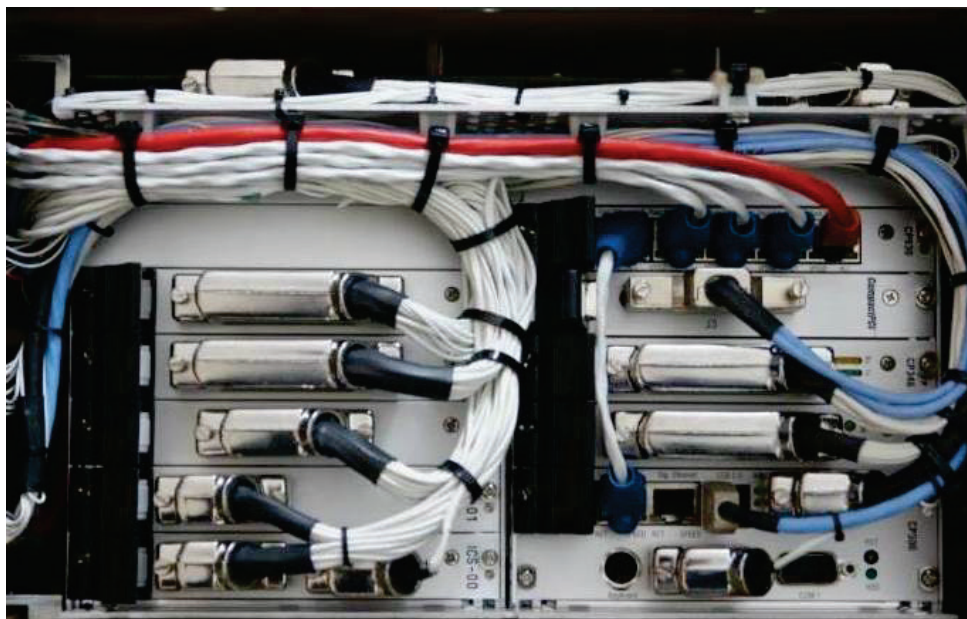
Rys. 4. Połączenia pakietów wewnątrz serwera komunikacyjnego SK-1 dla zintegrowanego systemu awionicznego śmigłowca W-3PL [8]
