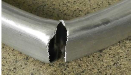
Rys. 9. Przykładowe zdjęcie profilu chłodzonego nadmuchem powietrza i poddanego próbie gięcia za pomocą giętarki 3-rolkowej
