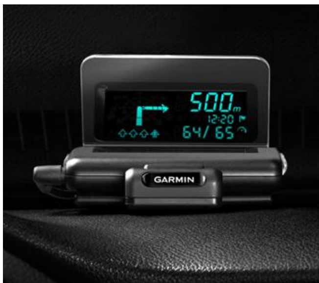
Rys. 3. Projektor HUD z własnym ekranem projekcyjnym (źródło: materiały reklamowe firmy GARMIN).
