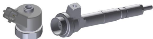
Rys. 1. Modele elektrycznej i mechanicznej części wtryskiwacza wykonane w programie Autodesk Inventor 2009
