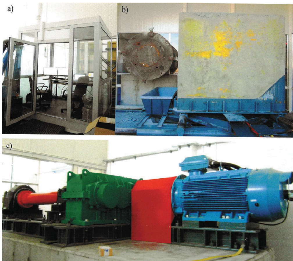
Rys. 10. Stanowisko laboratoryjne do badania poprzez frezowanie lub wiercenie obrotowe pojedynczymi narzędziami skrawającymi lub organami: a) kabina operatora; b) betonowa próbka wraz z zespołem jej mocowania i posuwu oraz testowy organ urabiający; c) napęd organu
