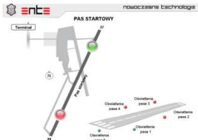
Rys. 2. Monitoring oświetlenia pasów lotniska
