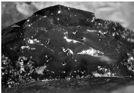
Rys. 1. Witryfikat z osadów z garbarni „Szczakowa” z procesu chemicznego strącania
