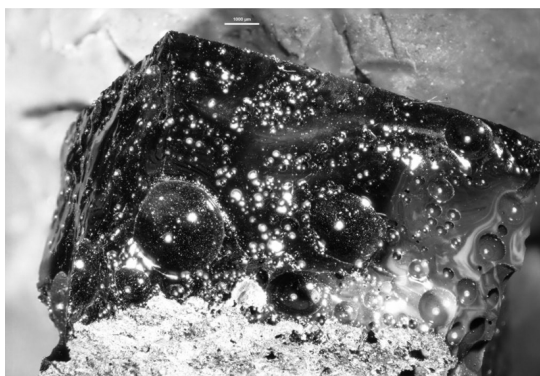
Rys. 2. Witryfikat z osadów z garbarni „Szcakowa” z procesu flotacji
