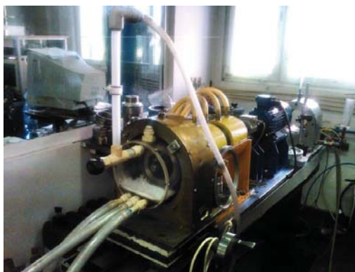
Rys. 3. Stanowisko do badania szczelności uszczelnień zespołów obrotowych maszyn
