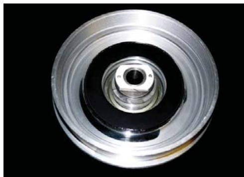
Rys. 4. Miejsce umieszczenia smaru w uszczelnieniu przed montażem na wale stanowiska
