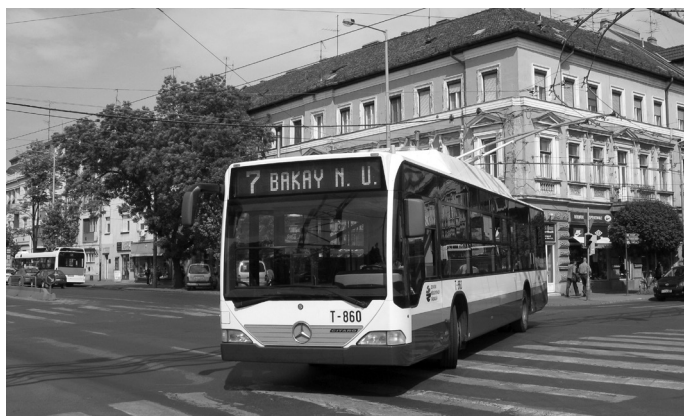
Fot. 5. Trolejbus skonstruowany z autobusu Mercedes Citaro 0530 w Szeged maj 2011, fot. A. Nemeth
