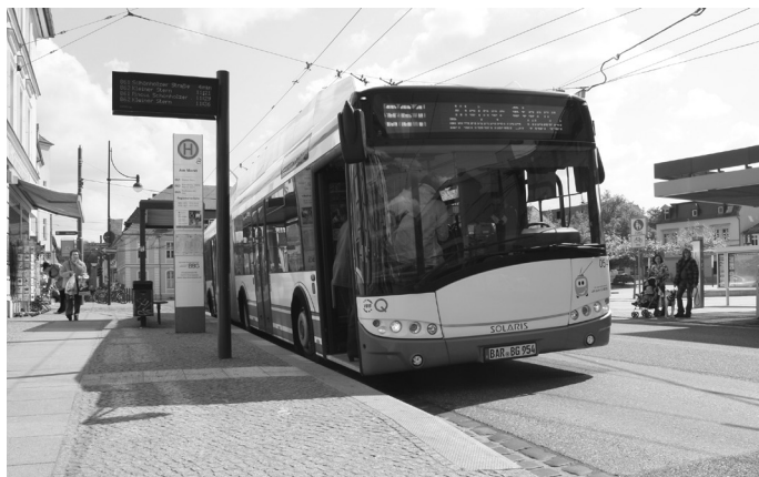
Fot. 3. Nowoczesny trolejbus Solaris Trollino 18 z superkondensatorami w Eberswalde, maj 2011, fot. M.Wolek
