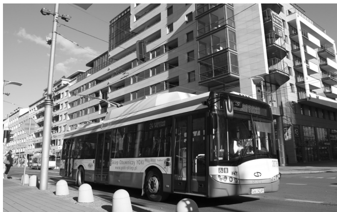
Fot. 4. Nowoczesny trolejbus Solaris Trollino 12 z baterijnym napędem pomocniczym w Gdyni, w październiku 2012, fot. J. Wensierski
