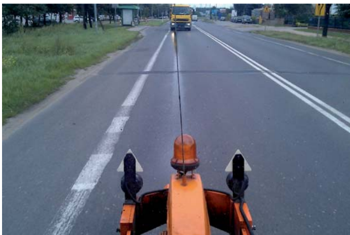
Fot. 3. Przyczepka pomiarowa SRT-3 (pomiar współczynnika tarcia nawierzchni wykonywany w prawym śladzie kół pojazdów)
