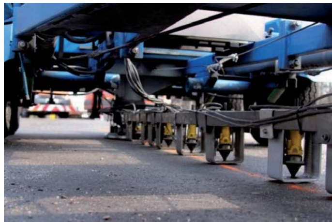
Fot. 1. Geofony pomiarowe oraz płyta naciskowa w zestawie FWD
