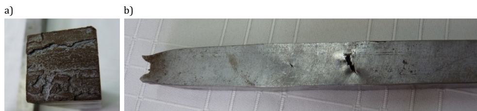
Rys. 3. Widok próbki po badaniu na rozwarstwienie: a) przekrój zerwanej próbki; b) próbka niewłaściwie przygotowana
