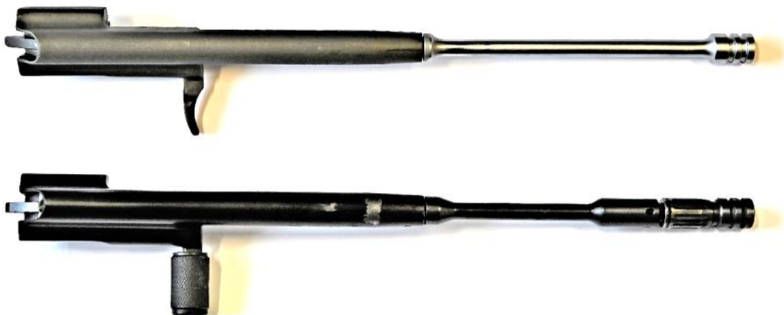
Fot. 4. Suwadła karabinków AKM (na górze) i AKM WS (na dole) [1]
