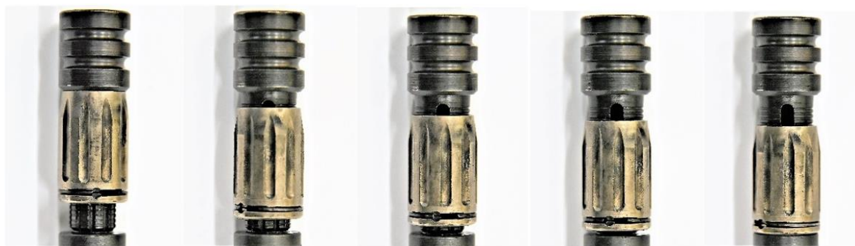
Fot. 7. Regulator tłoka gazowego w położeniach wykorzystywanych w badaniach.
