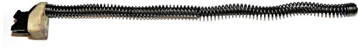
Fot. 3. Urządzenie powrotne z elastomerowym zderzakiem [1]
