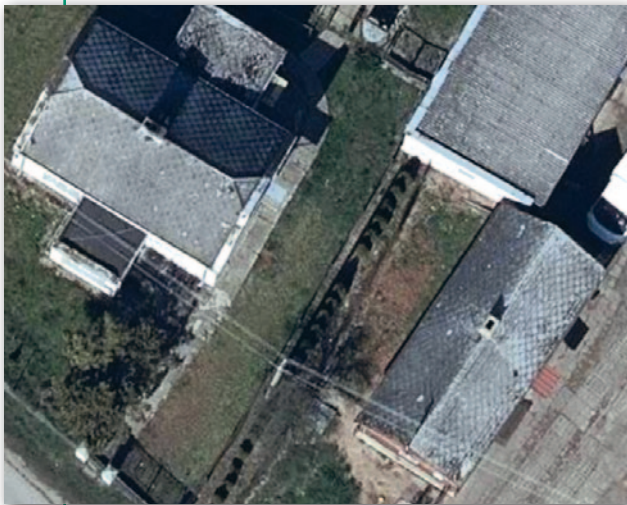
Różnice w wyglądzie tego samego pokrycia dachowego w zależności od kąta padania promieni słonecznych
